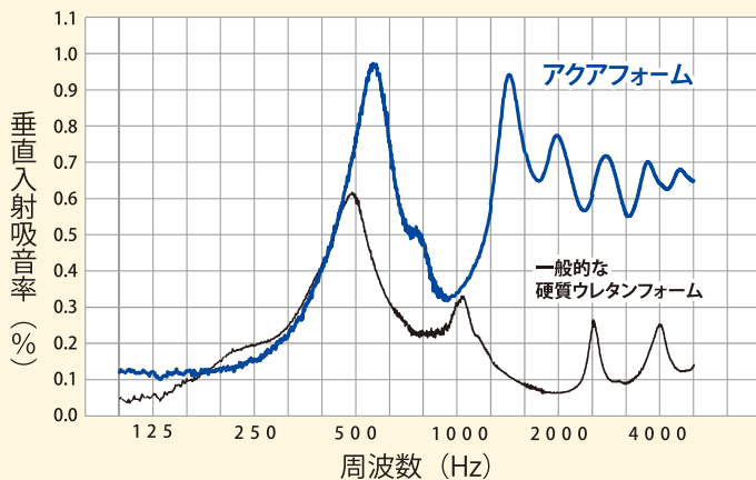
【垂直入射吸音率（伝達関数法）測定結果】 フォーム厚み：75mm
